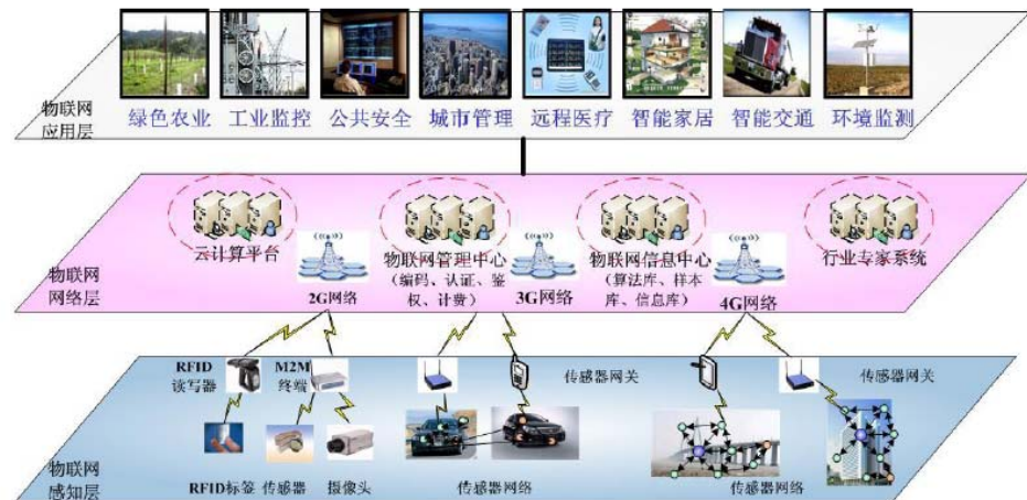
图 1 中国移动物联网层次架
