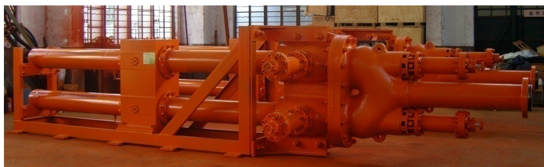
本公司开发研制的大口径锥形群阀泵
