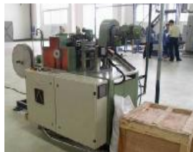
图 6、从德国引进的离路散热带制带机
