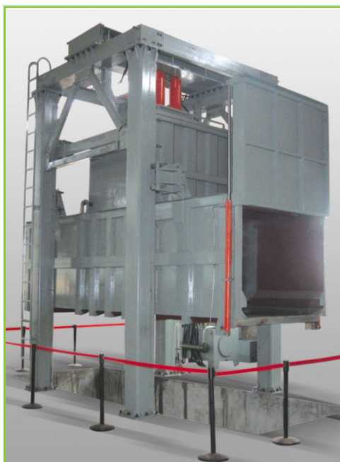
固定式垃圾转运站
