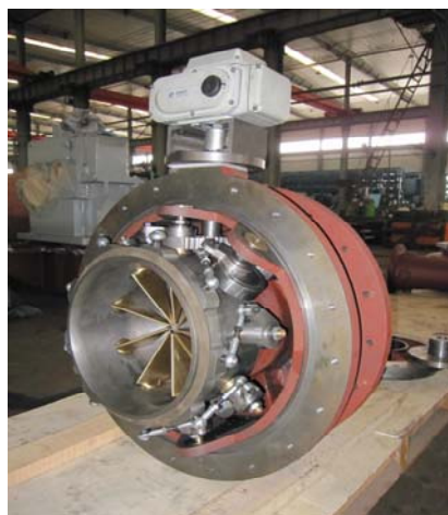
单级高速离心鼓风机进气导叶调节装置
