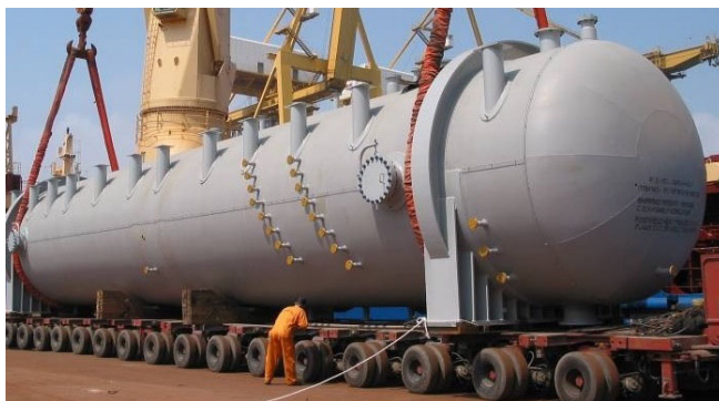
油、气、水分离器应用于康菲 30 万吨超大型浮式储油轮项目
