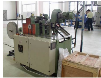
图 6、从德国引进的离路 散热带制带机
