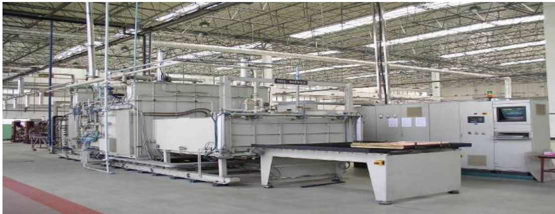
图 1、从美国引进的间隙式气体保护钎焊炉设备
