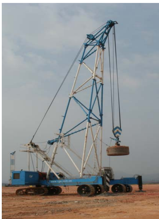
CGE800C 型强夯机侧面实物图
