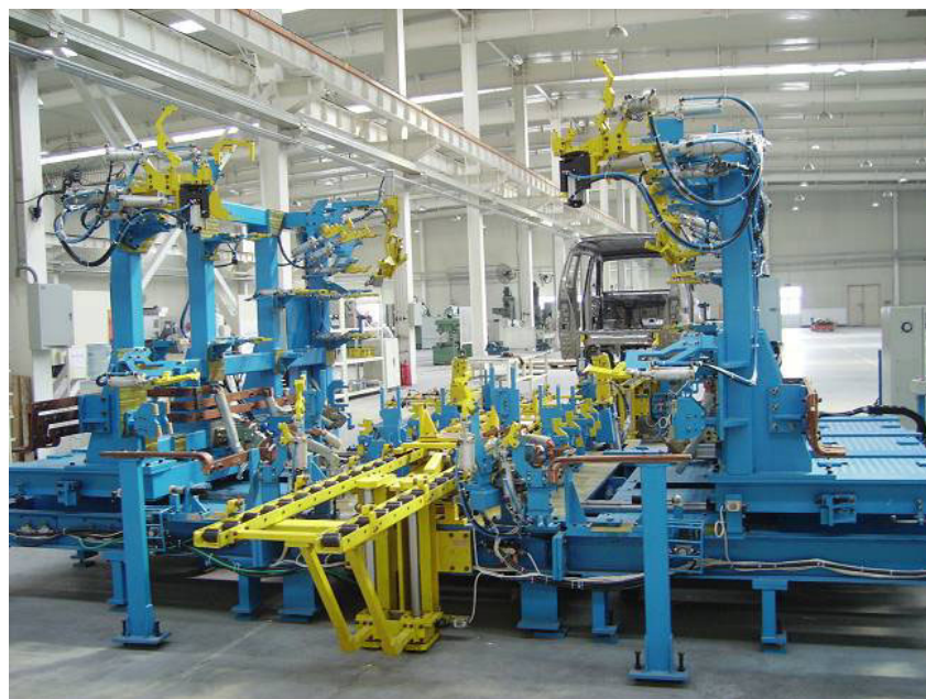
整车车身总成装焊夹具
