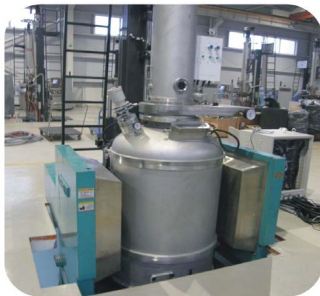
施加横向磁场的 CZ 生长炉
