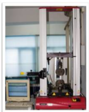
建筑防水材料物理性能试验
