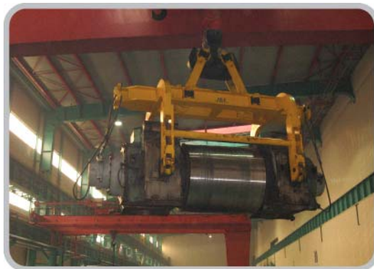
济南钢铁热轧厂 70 吨轧辊吊装
