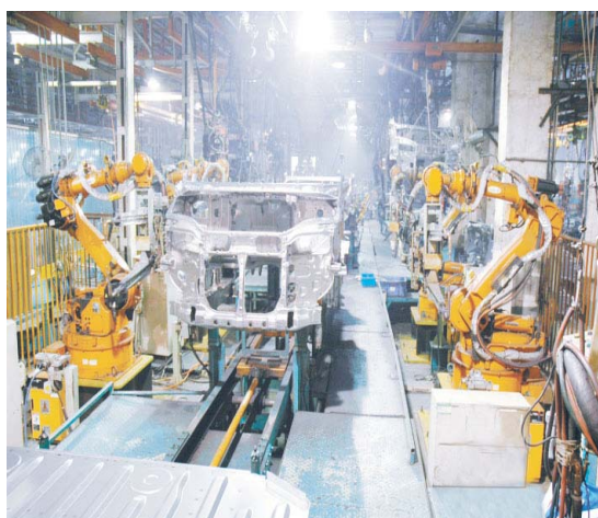
焊接机器人系统
