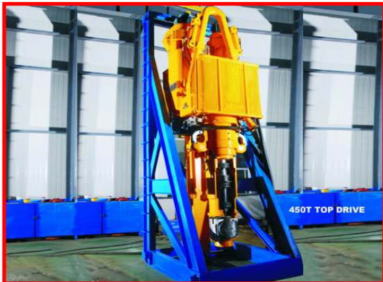
图：顶部驱动钻井装置
