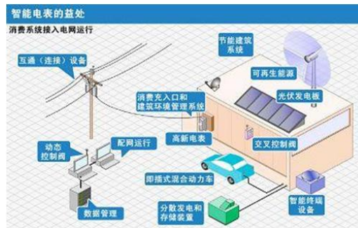
图 46、智能电表的功能示意图
