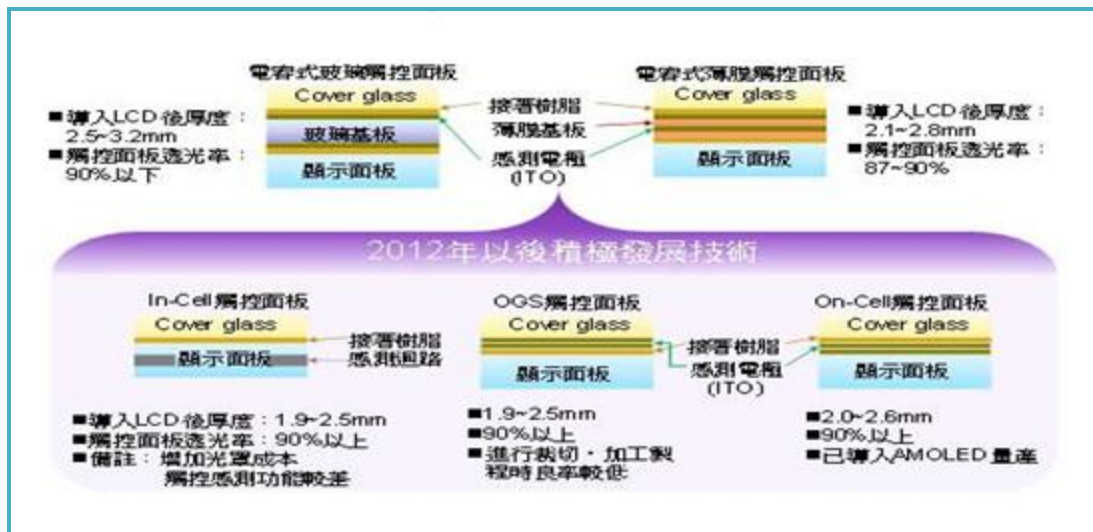
图 1: OGS、On-Cell、In-Cell 技术触摸屏结构图
