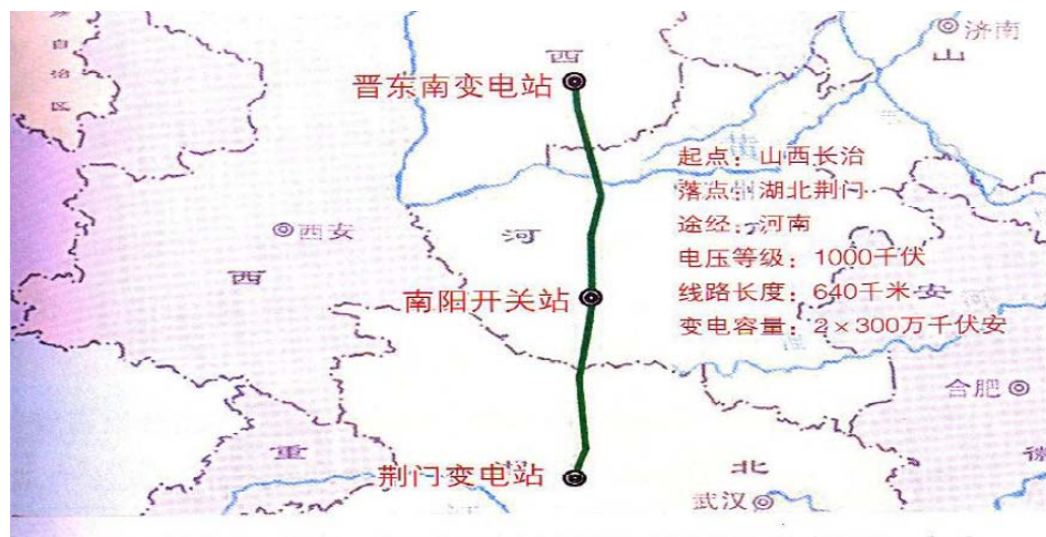
图 22 交流特高压示范线路：晋东南—南阳—荆门
