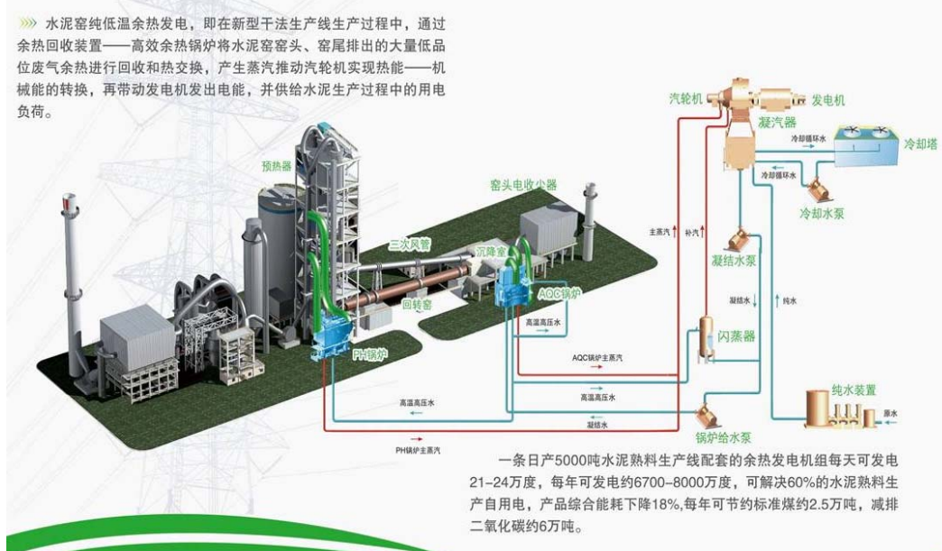
图 14： 水泥窑低温余热发电项目
