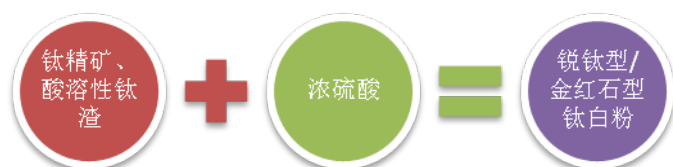
图 1：硫酸法钛白粉生产工艺
