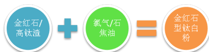
图 2：氯化法钛白粉生产工艺
