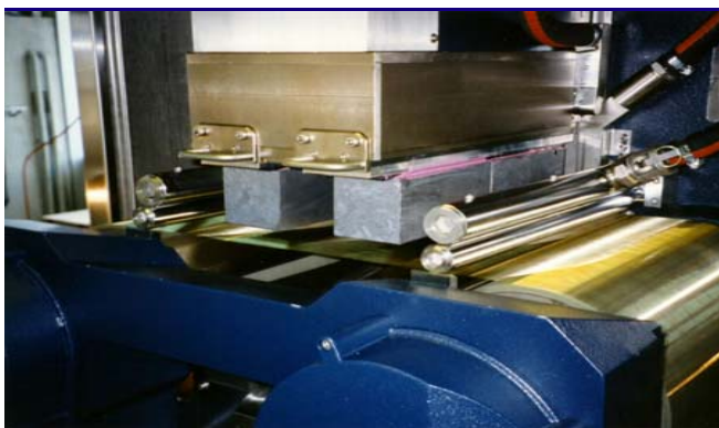
图 22: 硅块通过切割线组成的切割网
