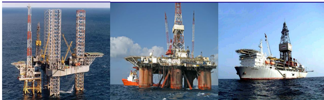
图 12：三类主要钻井平台（从左至右：自升式钻井平台、半潜式钻井平台、钻井船）
