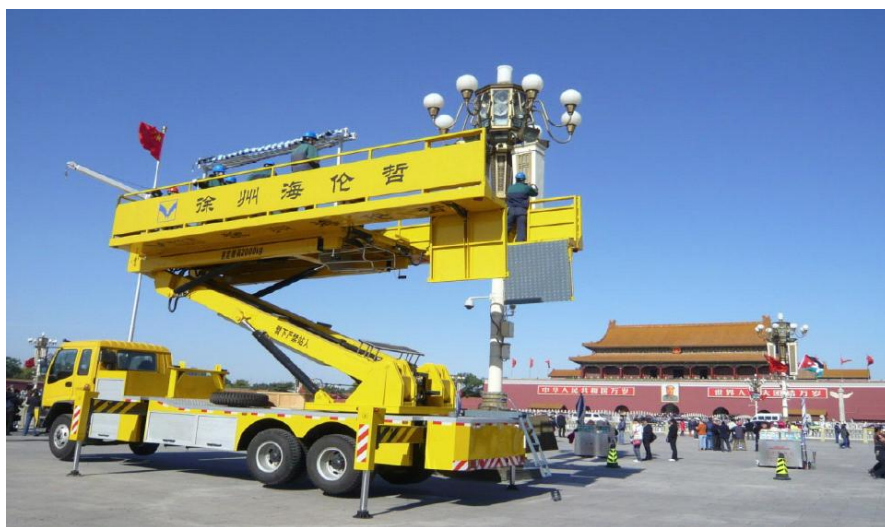
图 6：海伦哲用于天安门华灯检修的高空作业车
