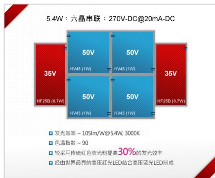
图 1：暖白光 LED：2 颗红光 LED+4 颗蓝光 LED
