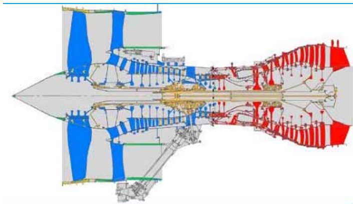
图表96：航空发动机中高温合金承力结构
