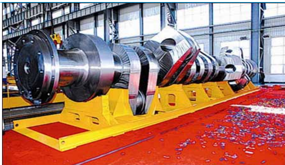
图表78：大连华锐曲轴研制成功 90 型大型船用曲轴
