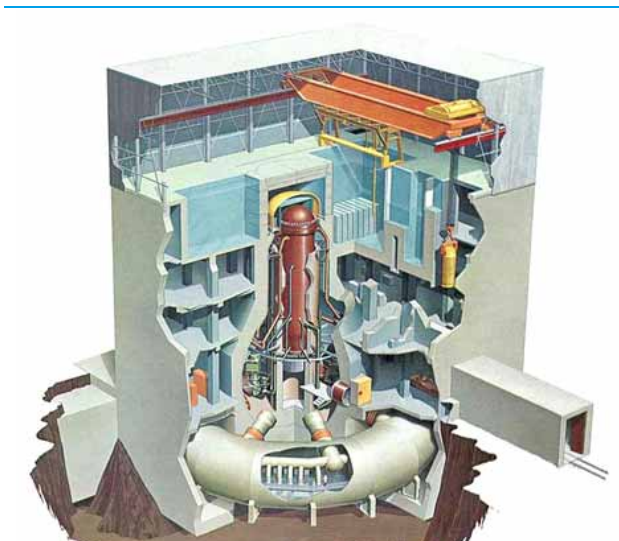
图表2：沸水核反应堆结构解剖图
