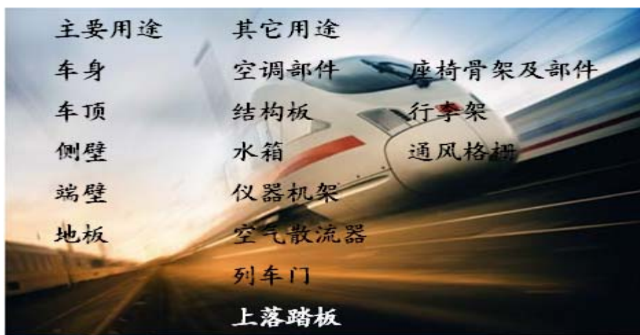
图 37: 铝挤压型材在高速列车上的用途
