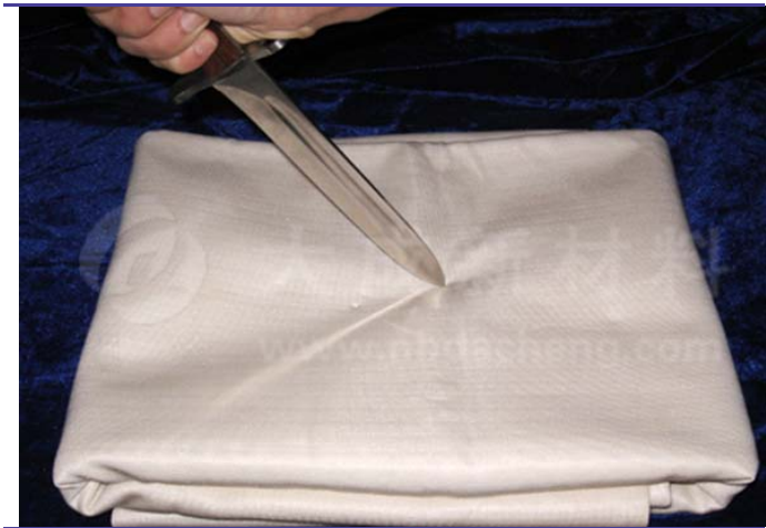
Figure 42 防切割 UHMWPE 纤维面料
