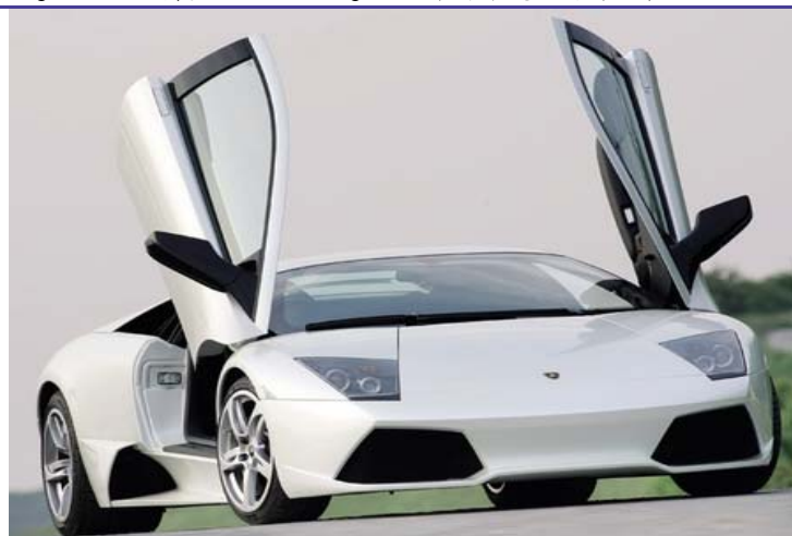
Figure 15 兰博基尼 Murcielago（碳素纤维复合材料占车总重 31%）
