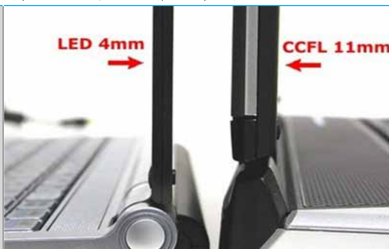
图表57: LED 和 CCFL 背光源厚度对比
