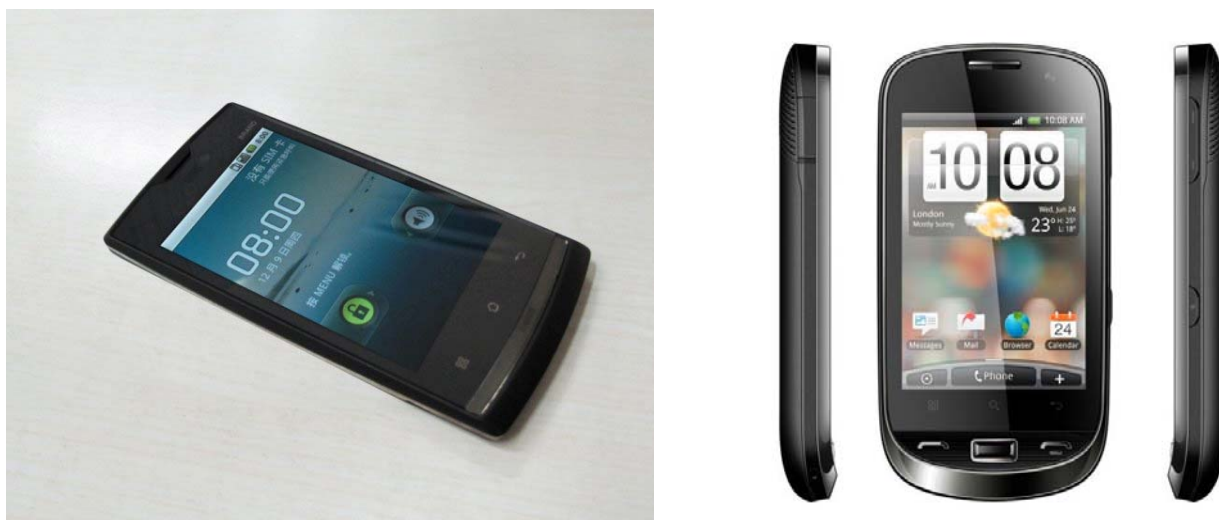
图表 2：高通 MSM7227 WCDMA/GSM 双模双待机芯片组 + Android 2.2 + 3.8 英寸电容触摸屏，成本 130 美元（左图）；配有 3.2 英寸电容触摸屏，成本 120 美元（右图）-- 将于 2011 年 2 月开始生产
