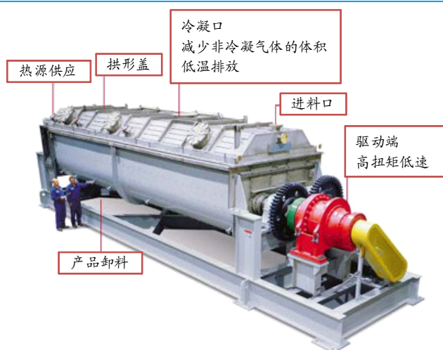
图表12：空心桨叶式蒸汽干化机构成
