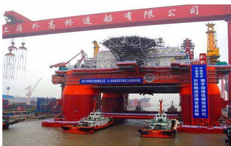
图 5：第六代半潜式钻井平台
