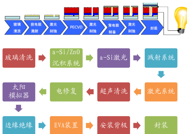
图 15: 薄膜电池生产工艺 (以非晶硅电池为例)
