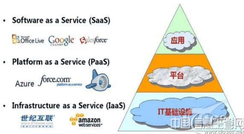
图表 6、云计算三层结构
