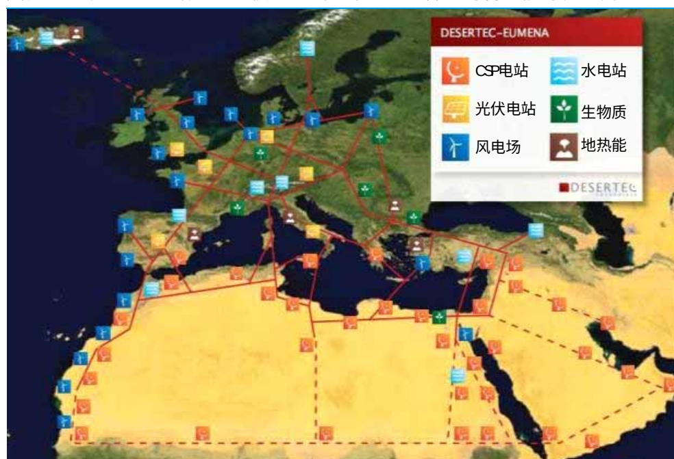
图表41：以 CSP 电站为主的覆盖欧洲、中东、北非的可再生能源供电网络
