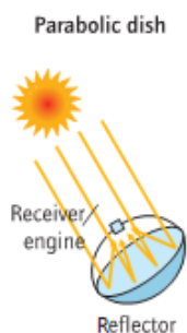
图 3 碟式聚光光热发电系统
