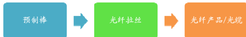
图 3 光纤光缆行业工艺生产过程
