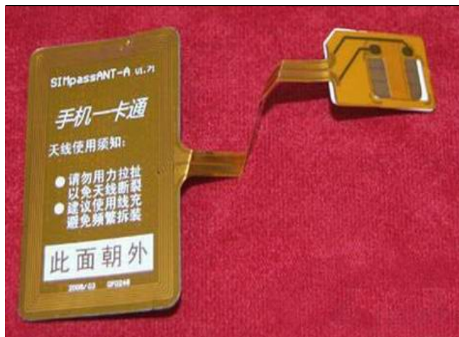
图表 7 SIMpass 卡需要加载很长的天线
