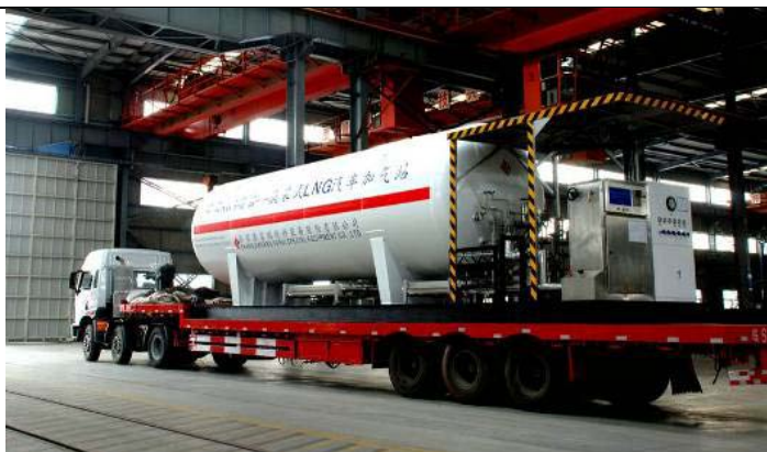
图 37：撬装 LNG 加气站
