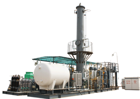
图 36：撬装天然气液化装置
