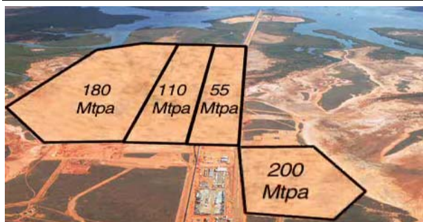
附图 3: FMG 黑德兰港口的 2 亿吨之路。港口模块化设计, 目前具备 5500 万吨运输能力, 若需求能够跟上, 则可快速扩张至 2 亿吨
