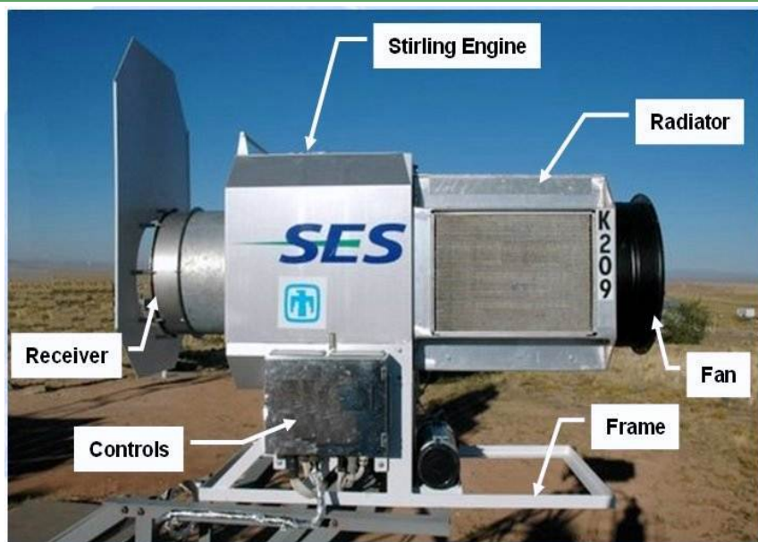
图24：SunCatcher系统中的PCU组件
