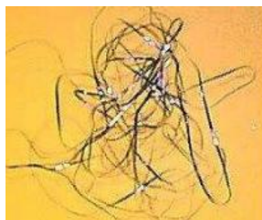
图2：快淬法制钕铁硼合金薄带图示
