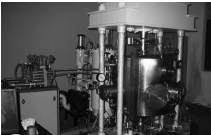
图表 10 实验室中用的真空感应热压炉
