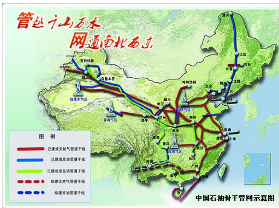
图 4.1 公司骨干管网示意图
