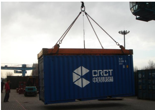
图9：传统集装箱吊装设备由老式吊钩简易改造而成
