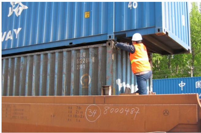
图7：传统的连接锁具需要人工配合操作
