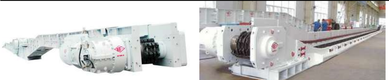
图 16：公司生产的转载机（左）和刮板输送机（右）
