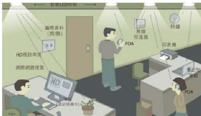
图 5：LED 之无限传输应用示意图
