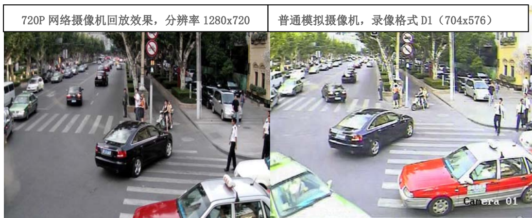
图 4 百万像素高清监控摄像头拍摄效果大大强于 D1 分辨率监控摄像头
