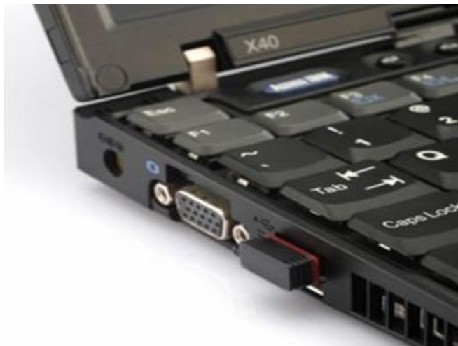
图 18：迷你接收器解决了无线鼠标接收器过长的问题
