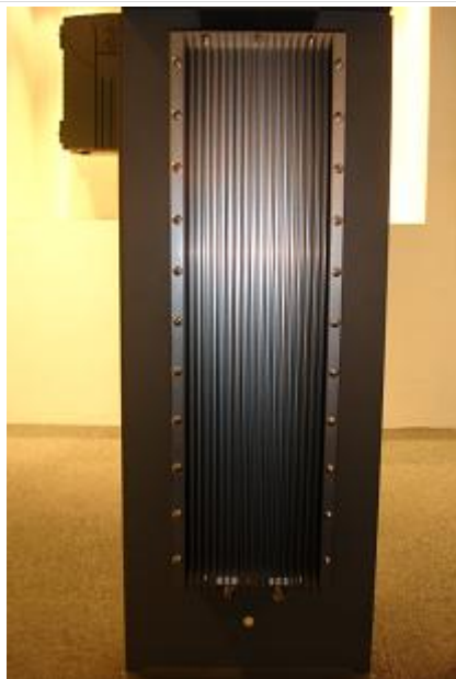
一体化 CDMA2000 基站
