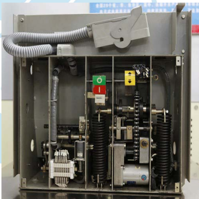
图 1：弹簧开关内部结构
